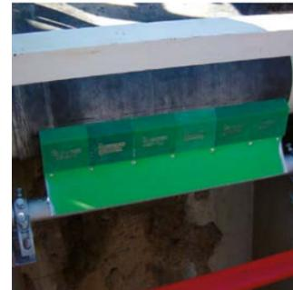
Барабанный скребковый сбрасыватель из полиуретана (PU)
