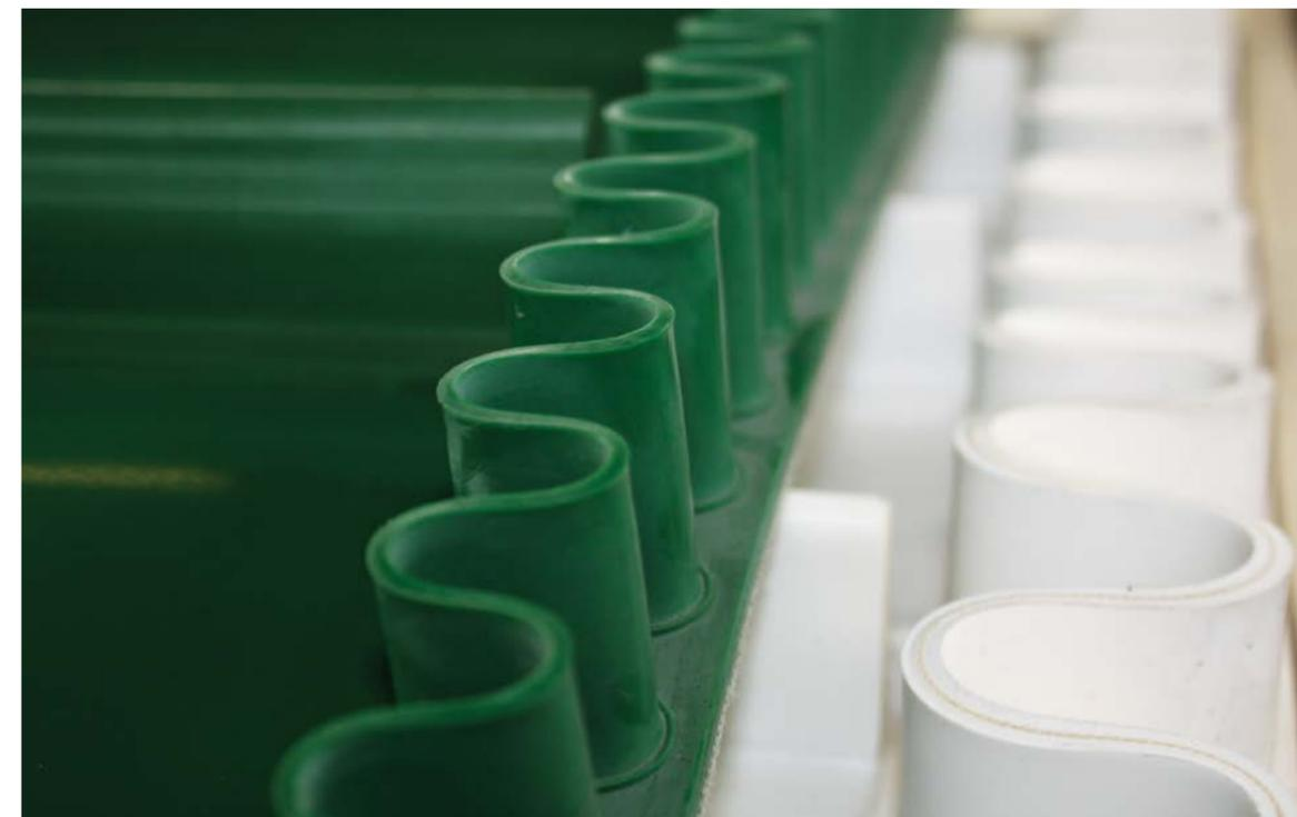
Конвейерная лента PVC с гофробортом
