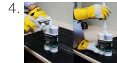
4. Verschluss entfernen und Mischkanüle befestigen
